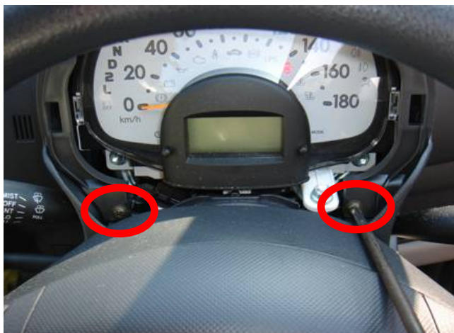
フロントカバーの背面カバーを外します 赤丸部のネジを 2箇所外します
