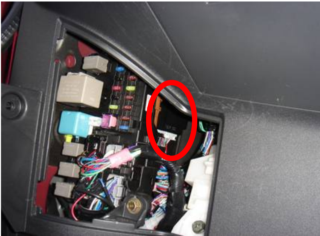
ヒューズBOXの奥にトランスミッション コントロールが有ります
