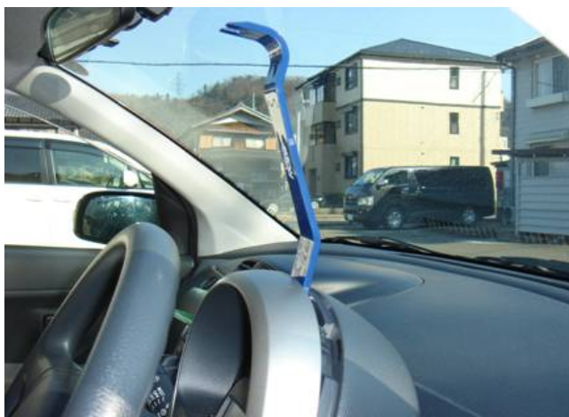
内張り剥がして フロントのカバーを外します ゆっくり差し込んで下さい
