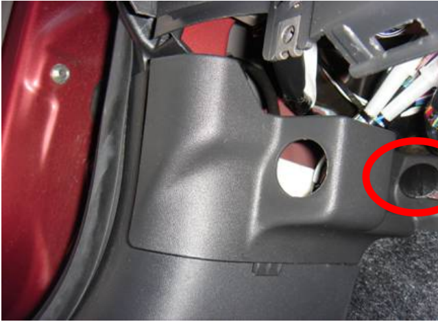
発炎筒を抜き 奥のネジを取ります カバーは 運転席と同じ手順で外します
