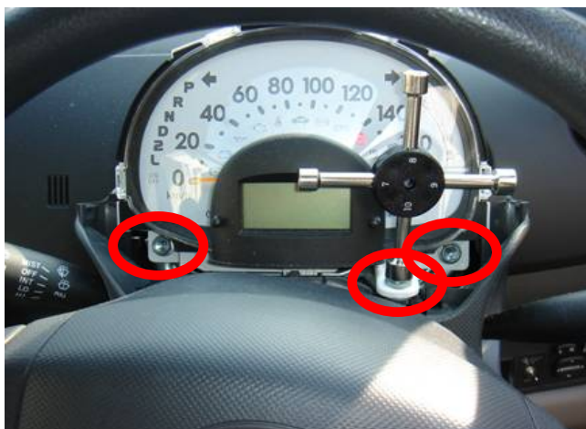
赤丸部のネジを3箇所外します 左右のネジは 狭く指が入らず非常に外しにくかったです
