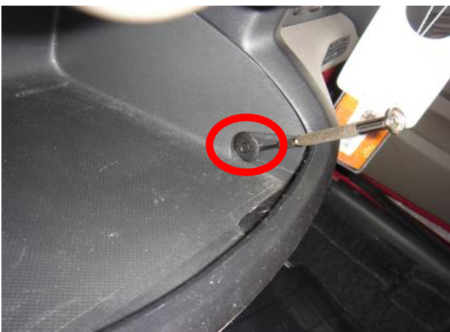
灰皿上の小物入れの運転席側の側面のピンを抜きます マイナスドライバーの先を差し込めば簡単に取れました
