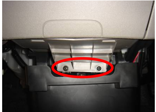
灰皿下のネジを 2箇所外します
